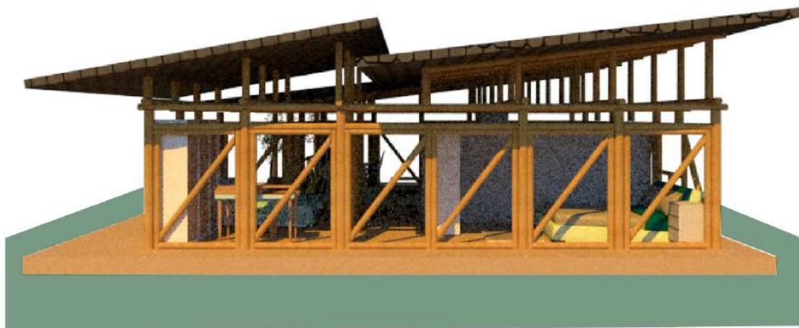
Figura 5: Fachada Oeste (6 painéis cegos de 1,1m)
