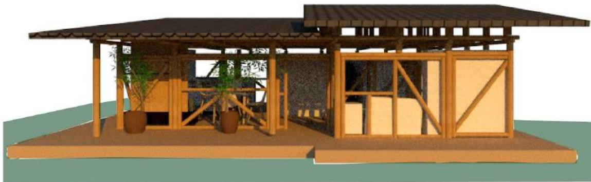
Figura 3: Fachada Norte (2 painéis cegos de 1,1m, 2 painéis janela de 2m e 1 painél porta de 1,1m)
