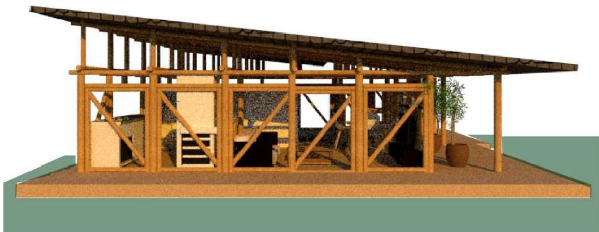
Figura 2: Fachada Leste (5 painéis cegos de 1,1m + 1,1 de varanda)
