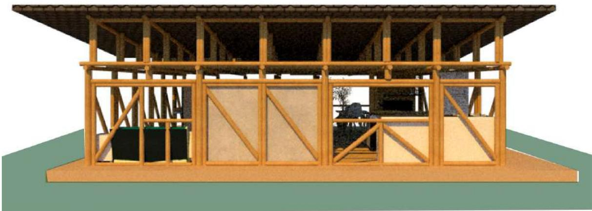
Figura 4: Fachada Sul (3 painéis cegos de 1,1m, 2 painéis janela de 2m)
