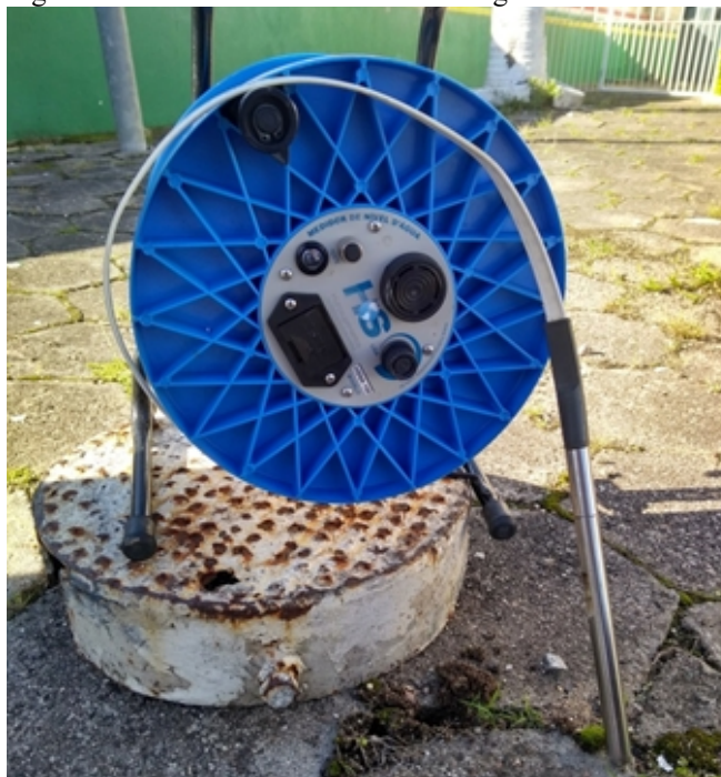
Figura 22: Medidor elétrico de nível de água.
