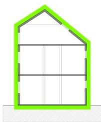
**Figura 1 - Isolamento térmico contínuo da envoltória. Fonte: adaptado de Wassouf (2014).**
