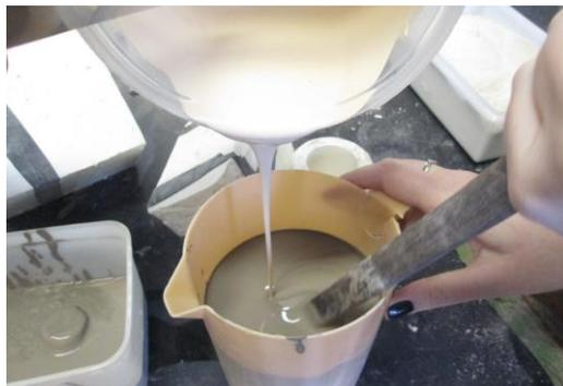
**Figura 3: Resíduo moído sendo adicionado á massa cerâmica pura. Fonte: elaborada pelas autoras.**
