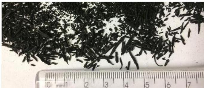
**Figura 1: Fibra de pneu. Fonte: elaborado pelos autores.**
