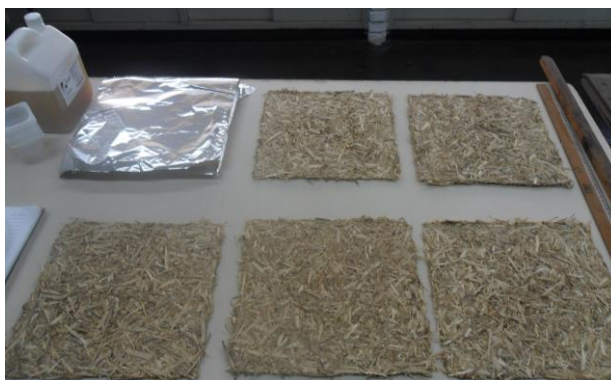
Figura 2: Preparación del colchón con partículas de Gynerium sagittatum . Fuente: elaborado por los autores.
