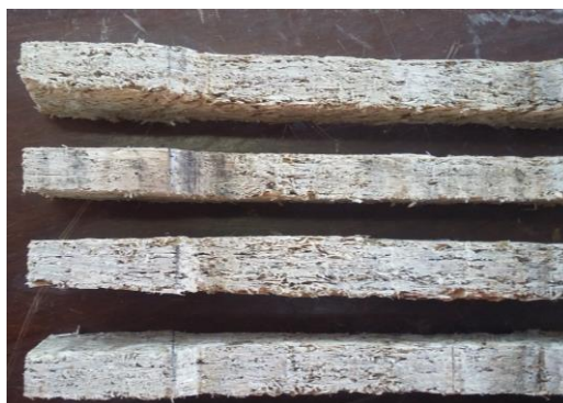
Figura 5: Diferencias en la consolidación de los cuerpos de prueba. Fuente: elaborado por los autores.
