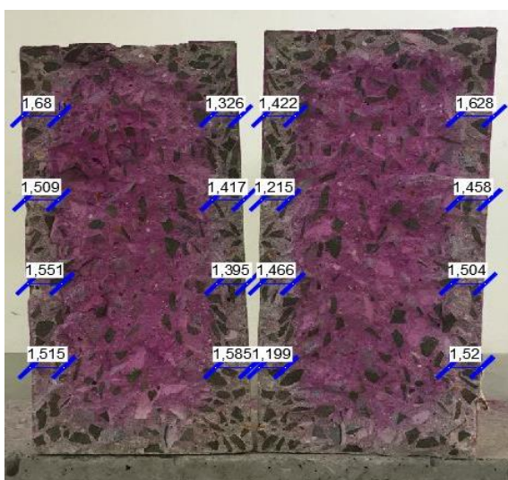
Figura 1. Carbonatação do concreto com substituição de 10% do agregado miúdo
