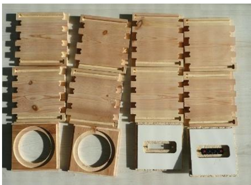
Figura 3 – Exemplo de encaixes feitos com CNC. Fonte: BARATTO, 2016.
