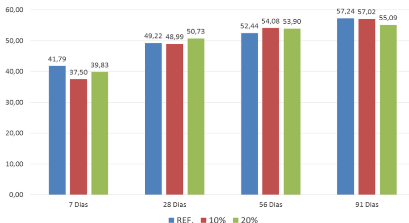
Gráfico 1. Resistência à compressão de concretos com agregado miúdo reciclado
