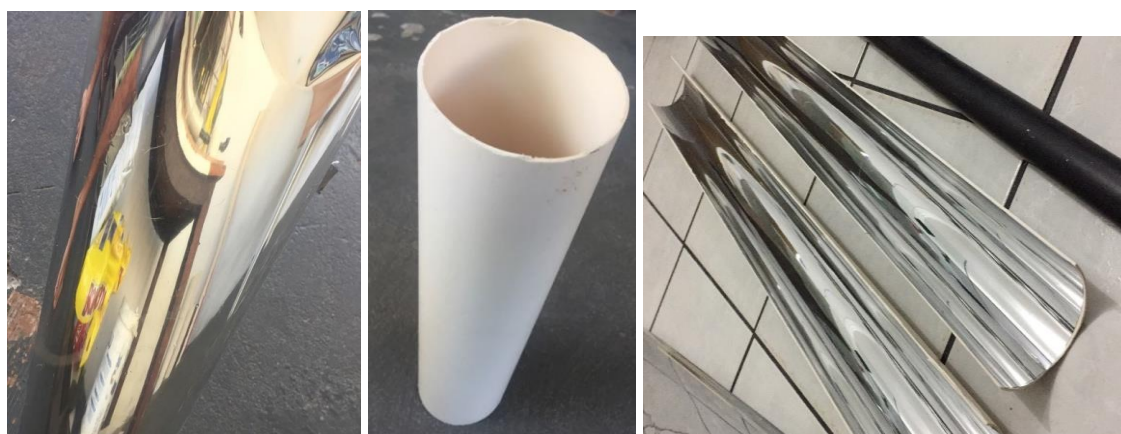
Figura 5: (a) Superfície reflexiva. (b) Tubulação de PVC. (c) Espelhos montados. Fonte: elaborado pelo autor.
