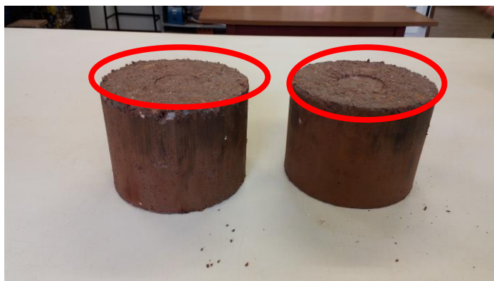
Figura 4 - Corpo de prova estabilizado após realização de ensaio de CBR. Fonte: próprios autores (2017).
