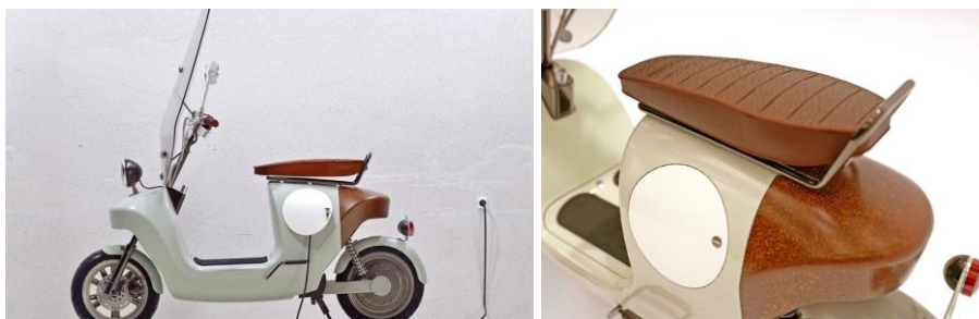
Figura 3: Motocicleta produzida em compósito com fibra de cânhamo e linho. Fonte: Vaneko (2017).
