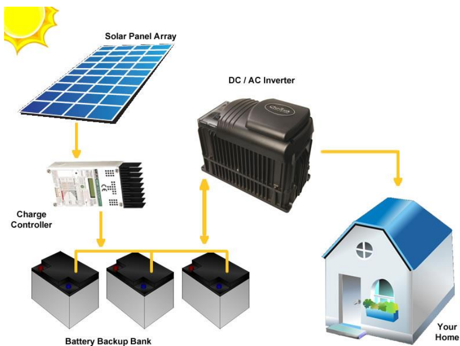
Figura 3: Esquema fotovoltaico off grid. Fonte: http://www.solarbrasil.com.br .
