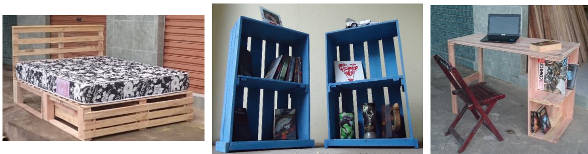
Figura 4. a) Cama feita totalmente em pallets com auxílio de cola PVA. b) Estante modulada em duas partes que ficam sobrepostas e possuem prateleiras removíveis, acabamento em tinta azul profundo; c) Mesa de Trabalho, verniz fosco marítimo. Fonte: imagens cedidas pela empresa 2
