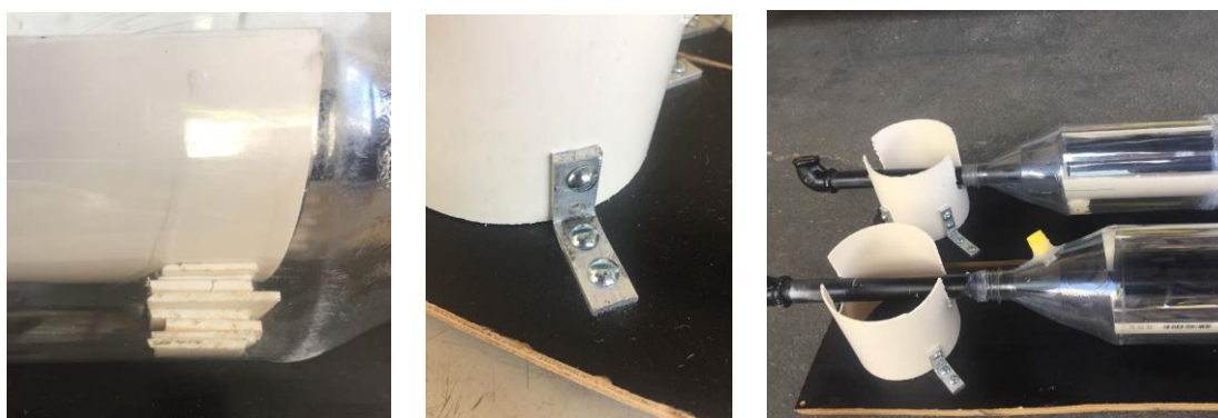
Figura 7: (a) Elevação em PVC. (b) Fixação da base. (c) Montagem. Fonte: elaborado pelo autor.
