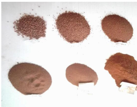
Figura 14: Ensaio de granulometria com peneiras GRANUTEST Fonte: autoral
