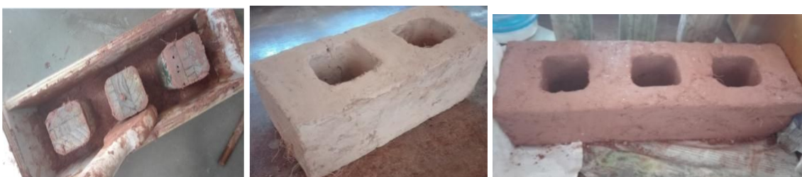
Figuras 19, 20 e 21: compactação: da massa na forma; bloco pronto dois furos; bloco ainda úmido três furos Fonte: autoral
