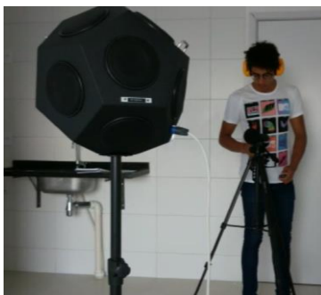
Figura 1: Realização do ensaio. Fonte: Os autores
