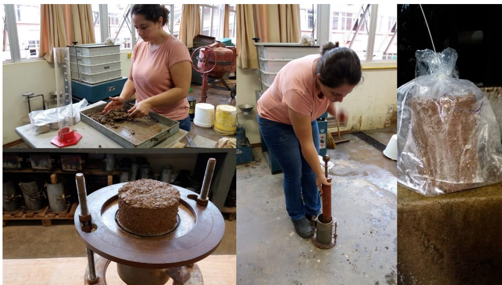
Figura 5 - Etapas de moldagem dos corpos de prova. Fonte: próprios autores (2017).
