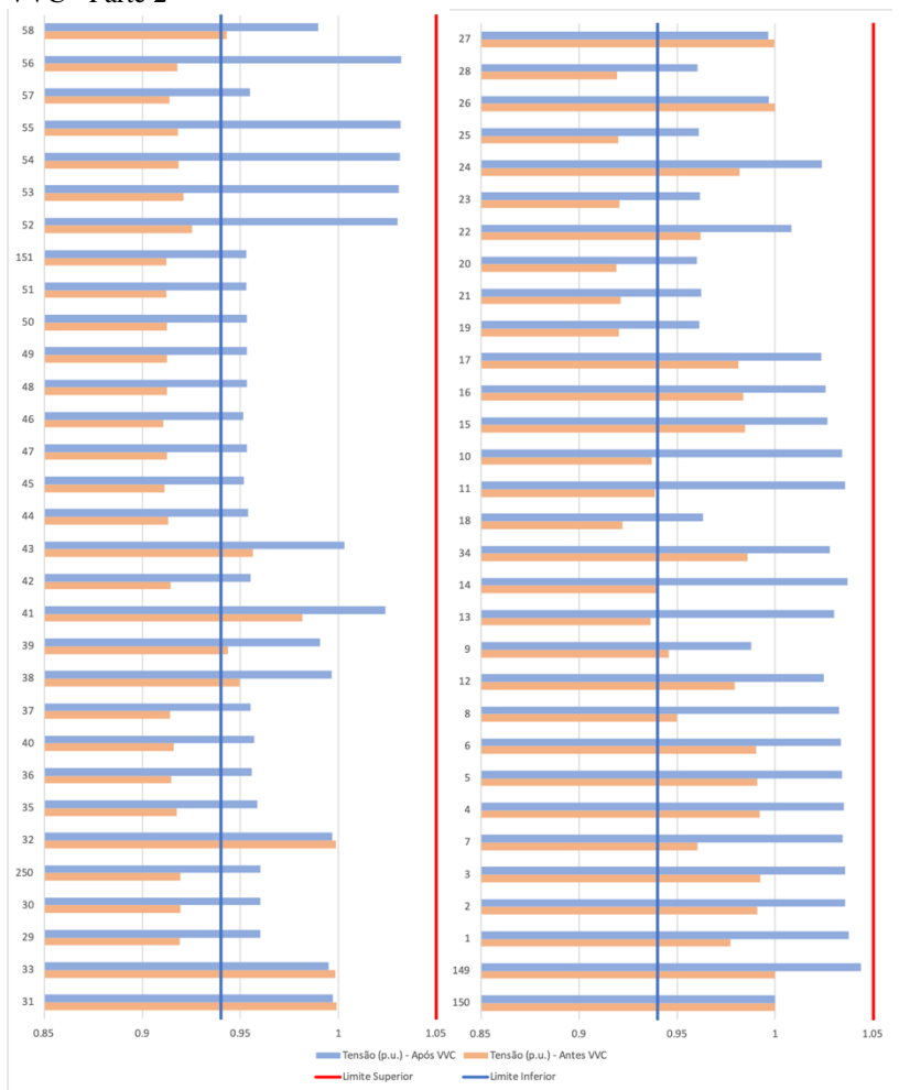
Figura 27 - Perfil de tensão nas barras do IEEE 123 antes e após a aplicação do VVC - Parte 2
