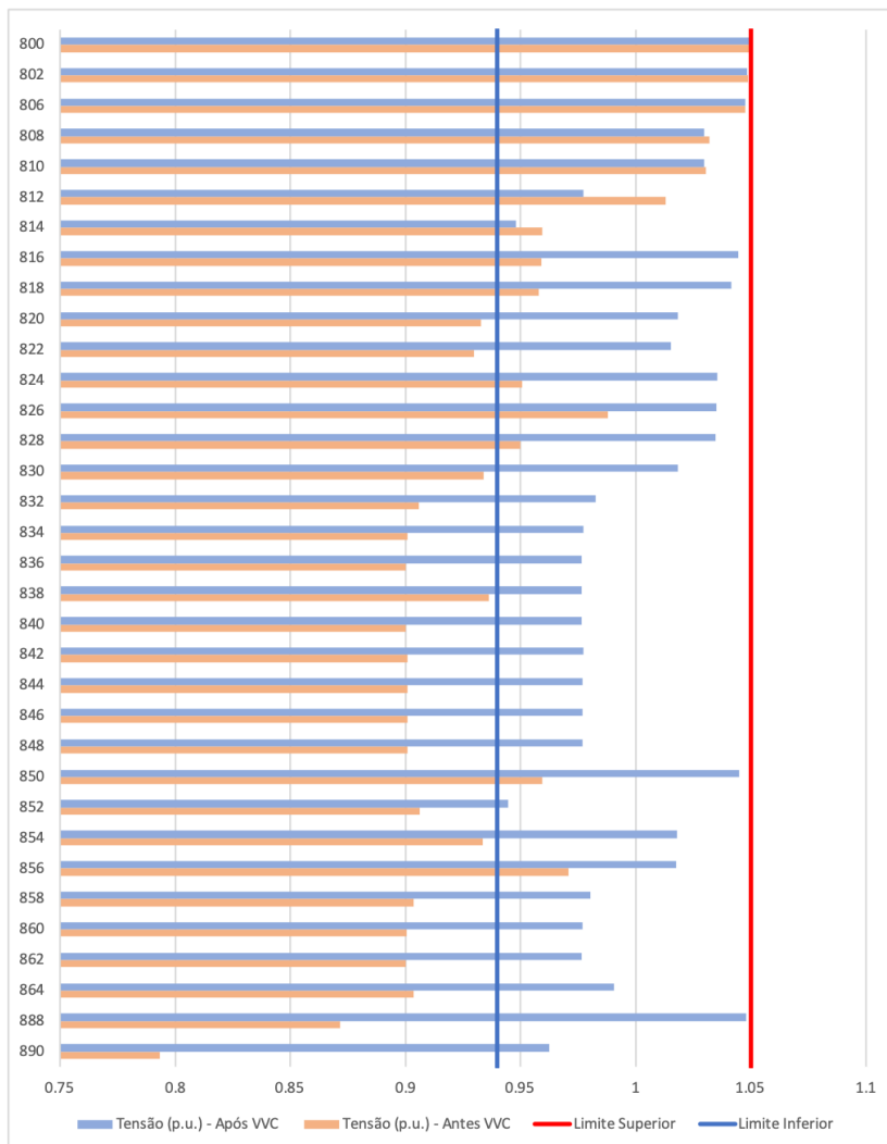
Figura 24 - Perfil de tensão nas barras do IEEE 34 antes e após a aplicação do VVC
