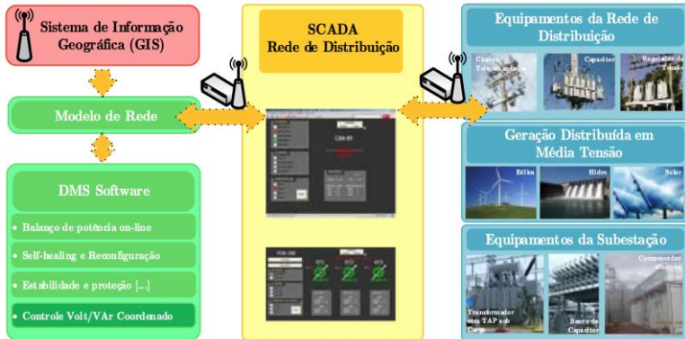
Figura 11 - Exemplo de arquitetura do sistema de distribuição
