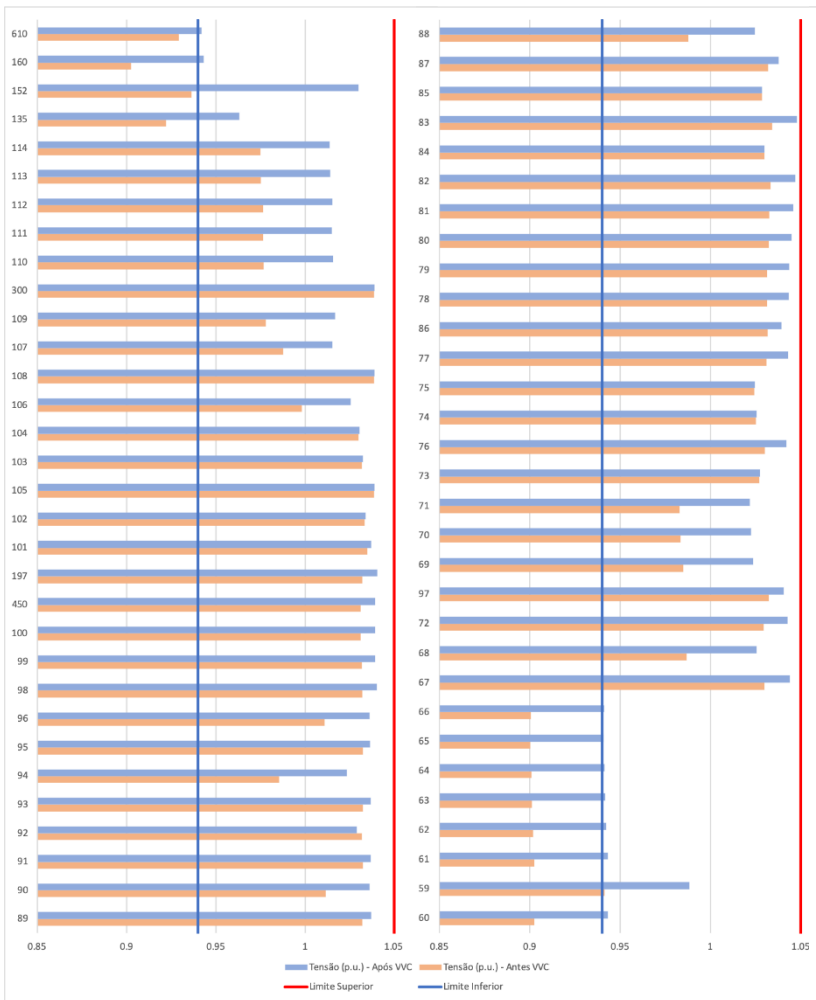
Figura 26 - Perfil de tensão nas barras do IEEE 123 antes e após a aplicação do VVC - Parte 1
