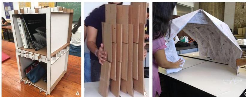
**Figura 3: Diferentes produtos de papelão. (A) Exemplo de mobiliário. (B) Exemplo de elemento como fechamento vertical. (C) Exemplo de uma cobertura. Fonte: acervo do autor.**
