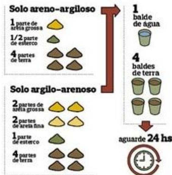
Figura 2: Dosagem dos materiais constituintes. Fonte: Bueno (2018)
