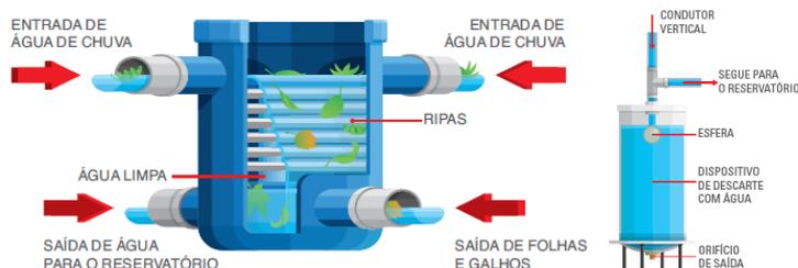
Figura 2: Filtro autolimpante e tonel descartes. Fonte: (FEAM, 2016)
