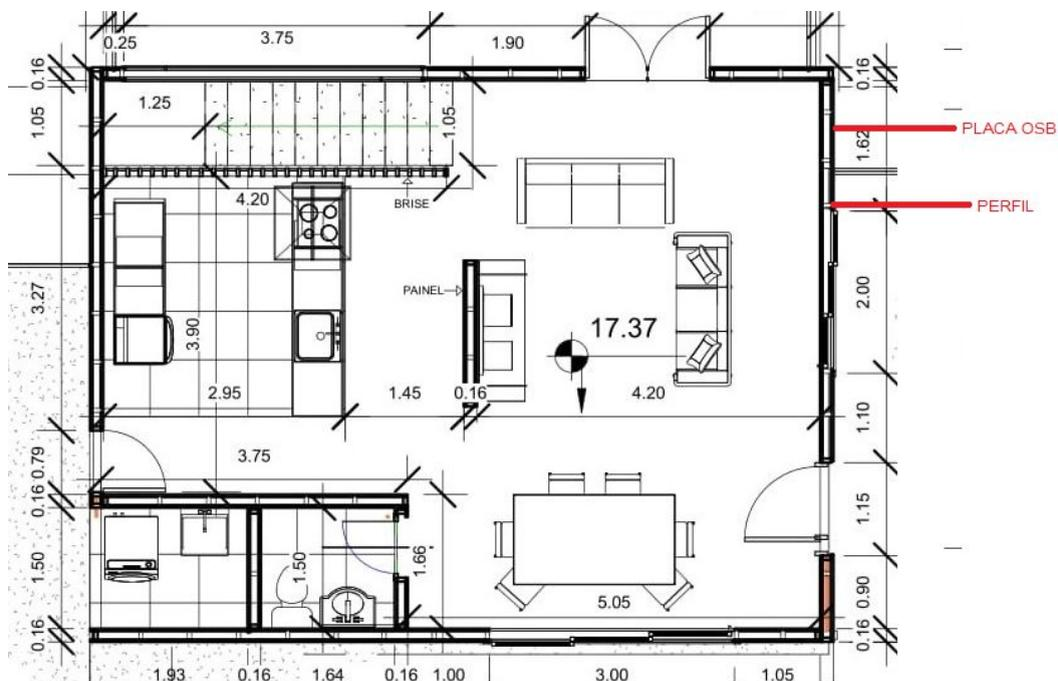
**Figura 11:** Detalhe da representação técnica do projeto executivo Wood frame gerado no Revit®-.
