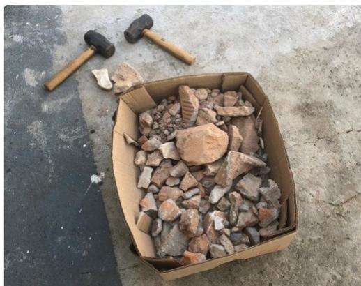
**Figura 2:** Marretas para fragmentação e amostras dos resíduos de construção e demolição. Fonte: elaborado pelos autores, 2018.
