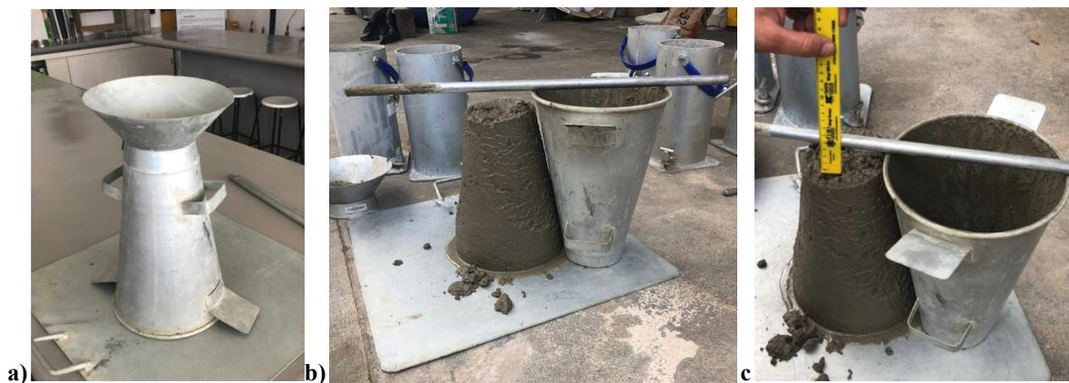
**Figura 3: Etapas do ensaio de Slump Test: a) Forma tronco-cônica utilizado no ensaio; b) e c) Leitura do abatimento com auxílio de uma régua. Fonte: elaborado pelos autores, 2018.**
