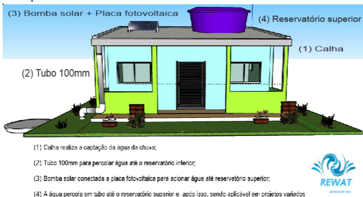
**Figura 2: Projeto Reaproveitamento Sustentável da Água da Chuva. Fonte: elaborado pelos autores.**
