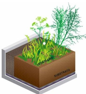
**Figura 2: Desenho esquemático da estrutura do telhado verde tipo intensivo. Fonte: <http://2030studio.com/telhado-verde-uma-opcao-sustentavel/2030>**
