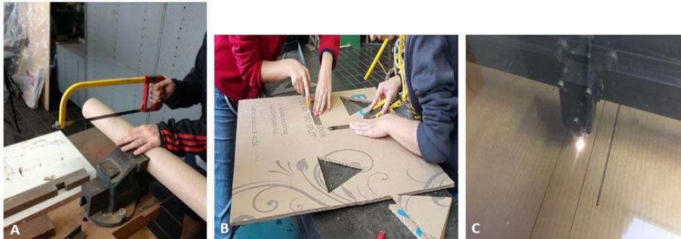
**Figura 5: Processo de corte do papelão. (A) Corte com serra. (B) Corte com estilete. (C) Corte a laser.**
