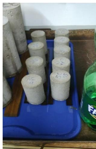
**Figura 11: Ensaio de absorção após 72 horas.**
