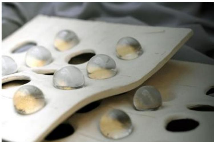
**Figura 1. Hidrocerâmica. Fonte: Hometeka (2018)**
