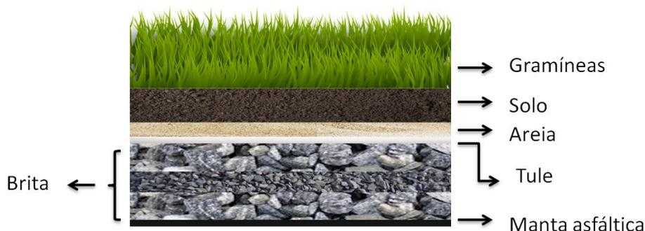
**Figura 4 – Montagem do Sistema Fonte: Elaborado pelos autores (2019).**
