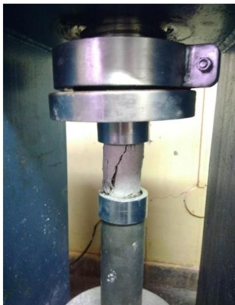
Figura 2 : Rompimento do corpo de prova em prensa automática
