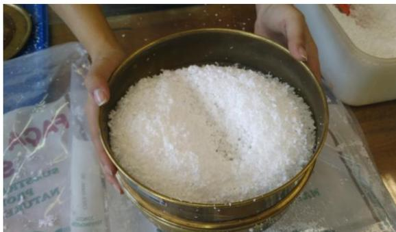
**Figura 2: Poliestireno expandido sendo peneirado. Fonte: Elaborado pelos autores.**
