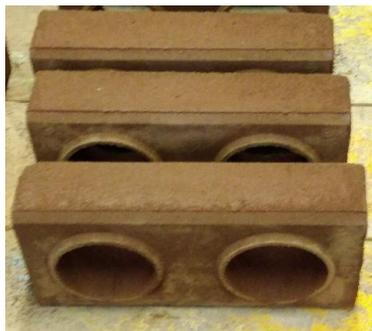
**Figura 3- Blocos após a moldagem. Fonte: elaborado pelos autores.**
