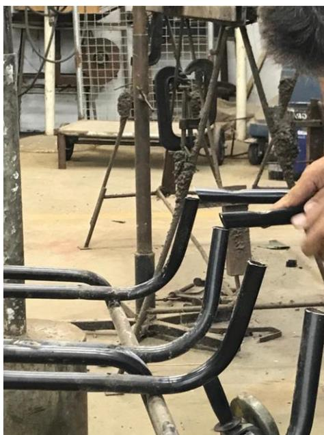
**Figura 6: Estruturas das mesas e cadeiras desmontadas e em fase de recorte. Fonte: elaborado pelos autores.**
