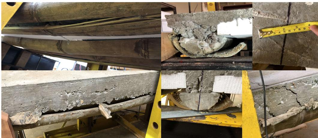
Figura 1: Mecanismos de rupturas das lajes (falha na aderência entre os colmos de bambu e o concreto). Fonte: elaborado pelos autores.
