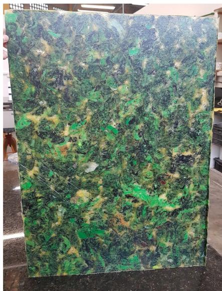
**Figura 3: Placa resultante da primeira fase de experimentações nas dimensões 600x450mm. Fonte: elaborado pela autora.**
