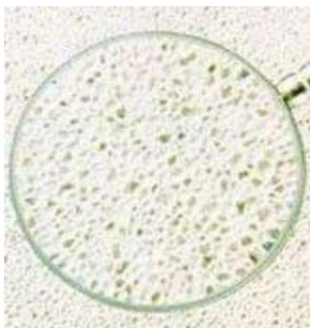
**Figura 1: Detalhes do Bloco de Concreto Celular Autoclavado (BCCA). Fonte: Bervig (2017)**
