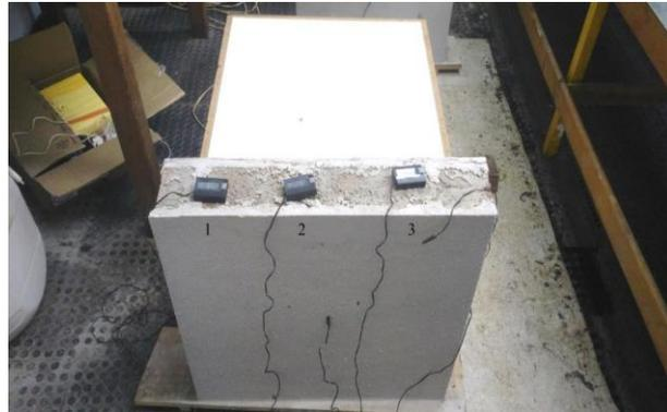
**Figura 3: Configuração dos termopares. Fonte: Elaborado pelos autores.**
