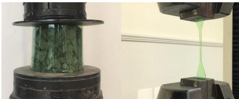
Figura 4: Ensaios de compressão e tração. Fonte: elaborado pelos autores.
