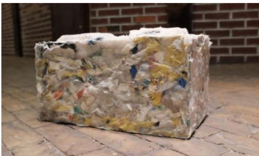
**Figura 3. Bloco Replast . Fonte: Cunha (2016)**
