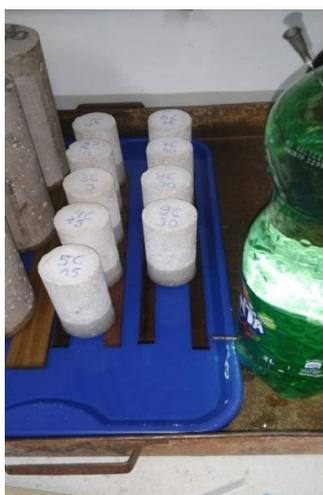
**Figura 10: Ensaio de absorção após 3 horas.**
