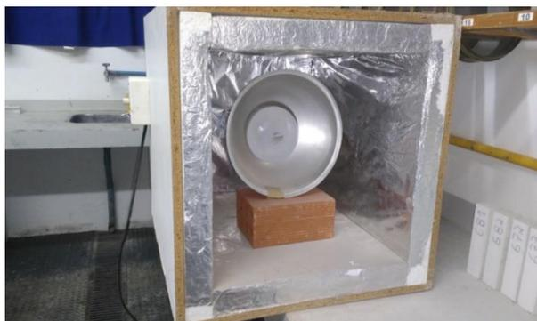
**Figura 2: Câmara térmica. Fonte: Elaborado pelos autores.**
