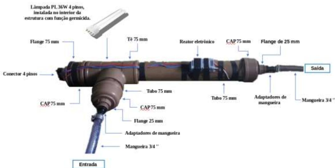
Figura 1: Protótipo desenvolvido do filtro UV. Elaborado pelos autores.
