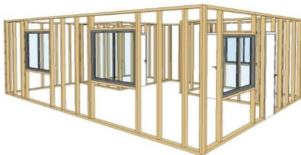
Figura 5: Vedações verticais, montantes e módulos para janelas. Fonte: SOUZA (2018).
