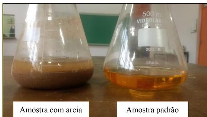
**Figura 2: Teor de matéria orgânica no agregado reciclado misto. Fonte: elaborado pelos autores.**
