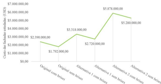
Figura 15 – Custo de construção das fachadas estudadas (projeto original e das alternativas). Fonte: elaborado pelos autores.
