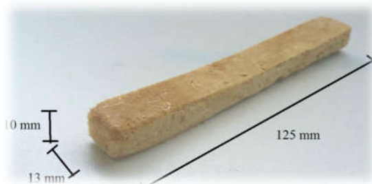
Figura 2: Espécime PU-GPA para teste de inflamabilidade horizontal, com 40% de lodo de vidro, 40% de lodo de alumínio e 40% de PET com relação a massa inicial do PU. Fonte: elabora do pelos autores.
