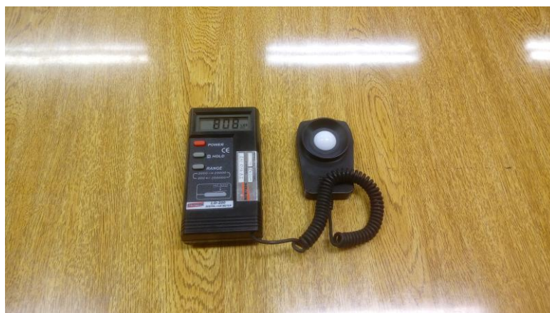
Figura 2 – Luxímetro sob a mesa. Fonte: elaborado pelos autores.
