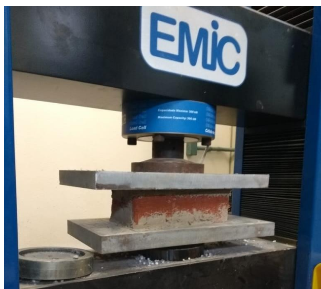
Figura 5: Máquina para ensaio de compressão, da marca EMIC. Fonte: Elaborado pelos autores.
