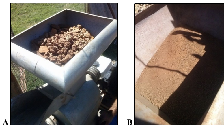
Figura 4: Processo de moagem do lodo. Fonte: elaborado pelos autores, 2016.
