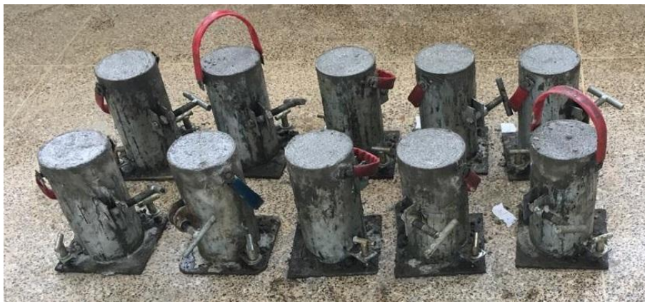
Figura 2– Corpos de prova de concreto. Fonte: Arquivo do autor (2018).
