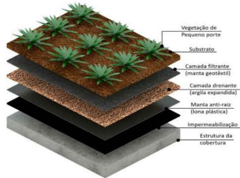
Figura 2: Montagem dos componentes do Sistema de telhado verde. Fonte: Scherer; Alves e Redin (2018).
