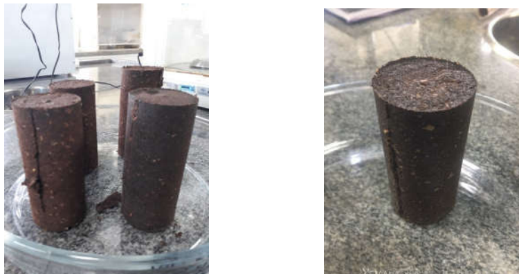
Figura 3: Combustíveis sólidos confeccionados com biomassas de 100 g de casca de batata inglesa e 70 g borra de café expresso. Fonte: elaborado pelos autores.
