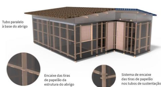
**Figura 44: Vista da estrutura interna do abrigo.**
