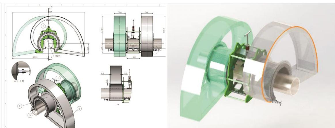
**Figura 9: Desenho técnico e imagem renderizada do modelo virtual do artefato para suportação de tubulações cilíndricas terrestres ou submarinas desenvolvido pelo laboratório de robótica do Centro de Pesquisas da Petrobras - CENPES. Fonte: Elaborado pelos autores.**
