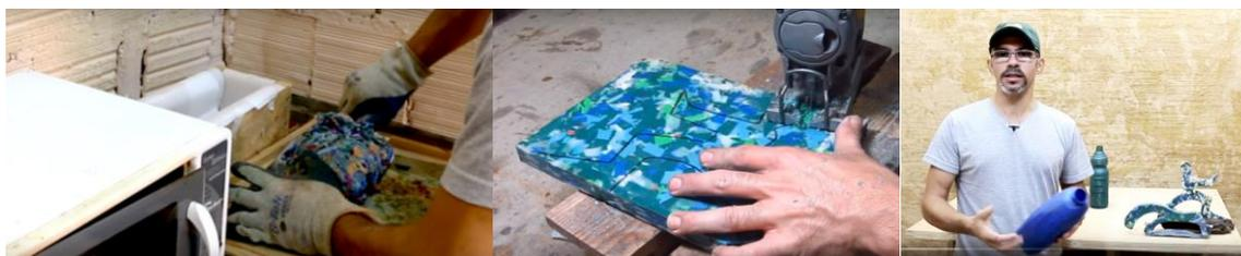
À esquerda: plástico fundido sendo retirado do forno com auxílio de uma espátula. Ao centro: corte da chapa de plástico utilizando uma serra tico-tico. À direita: Adilson Pinheiro ao lado das peças finais.
