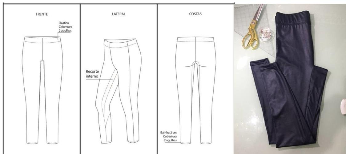
**Figura 10: desenho técnico do modelo aprovado e peça-piloto. Fonte: elaborado pelos autores**
