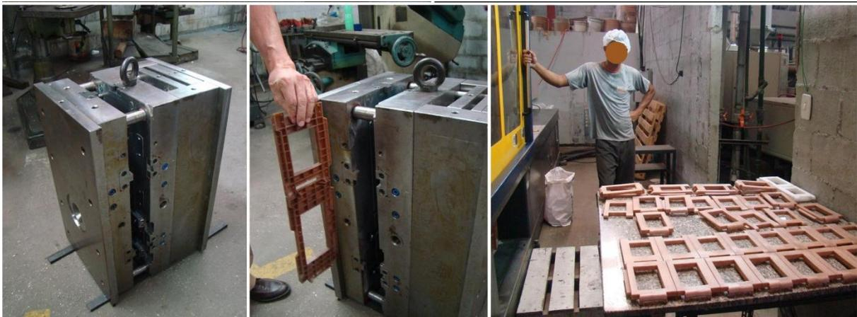
Figura 07 - Fabricação de moldes e peças para validação
