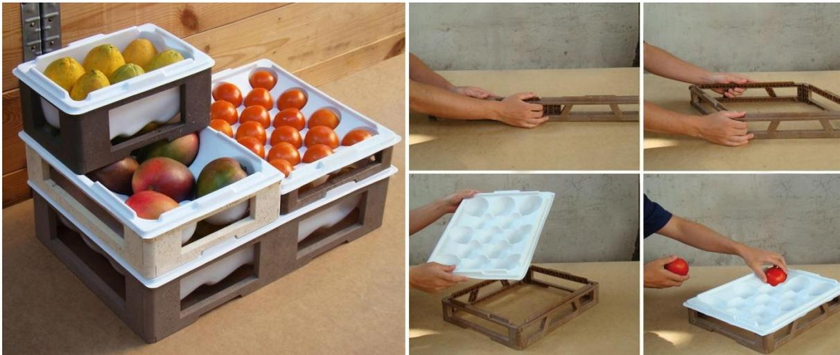
Figura 11 - Solução final para embalagens de mamão, manga e caqui. Embalagens paletizáveis e unitizáveis (à esquerda). Esquema de montagem das embalagens, com base dobrável e bandeja empilhável para facilitação do transporte (à direita)
