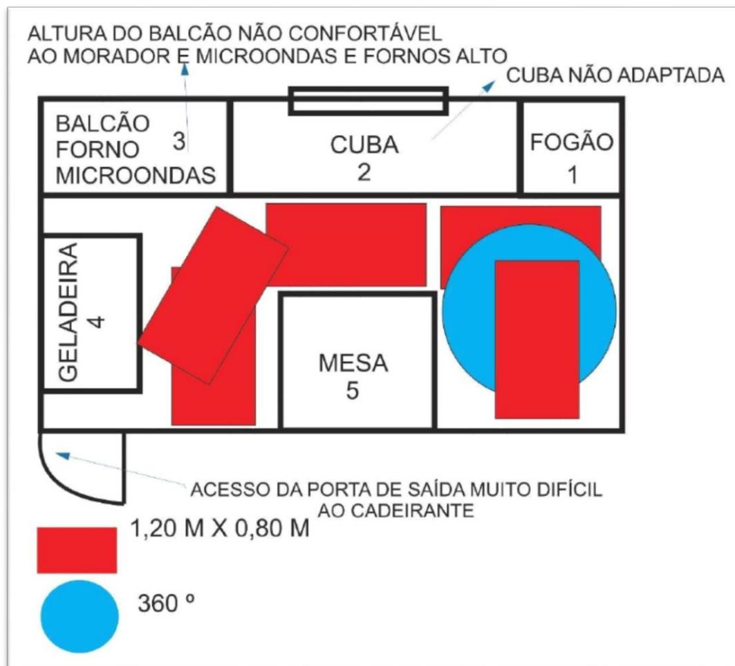
Figura 7 Cozinha B Planta esquemática. Fonte: autoras, 2017
