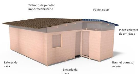
**Figura 22: Perspectiva frontal do abrigo. Fonte: elaborado pelos autores.**
