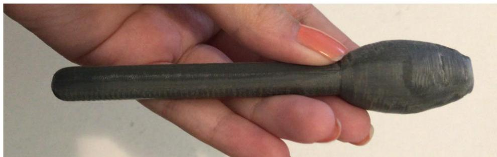
**Figura 8: Prótese impressa na impressora 3D. Fonte: elaborado pelos autores.**
