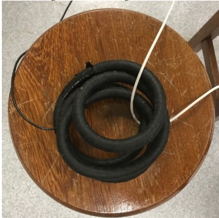
Figura 7 - Bobina de Rogowski utilizada
