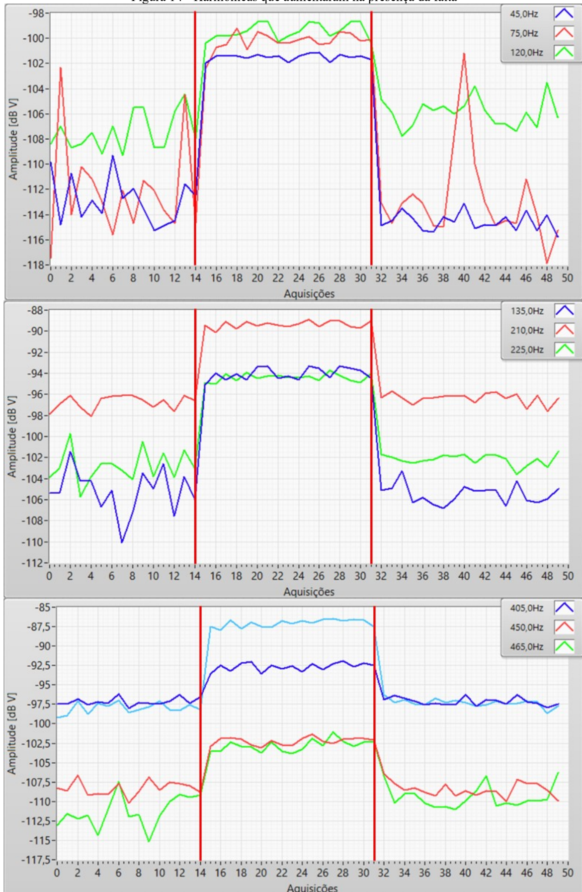
Figura 14 - Harmônicas que aumentaram na presença da falta
