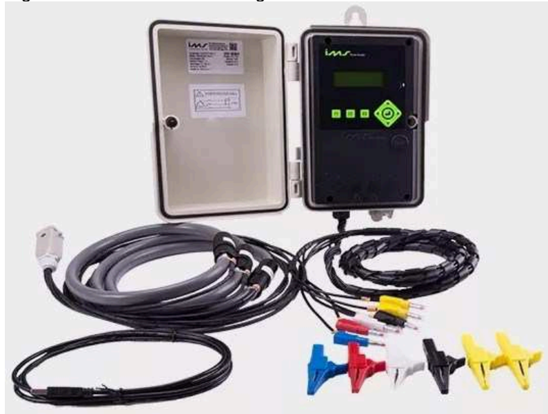
Figura 14 –Analisador de Energia Powernet P600.
