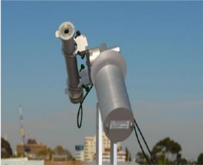
Figura 12 - Sistema de um pireliômetro.
