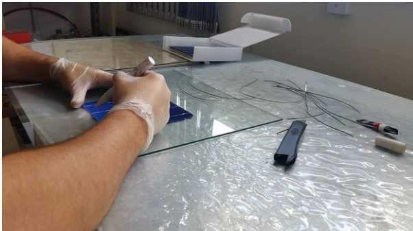
Figura 88 – Caneta de fluxo nos terminais das células fotovoltaicas.
