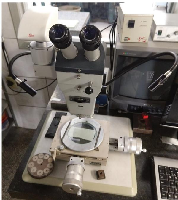
Figura 5 – Microscópio óptico com iluminadores bilaterais do LMP.
