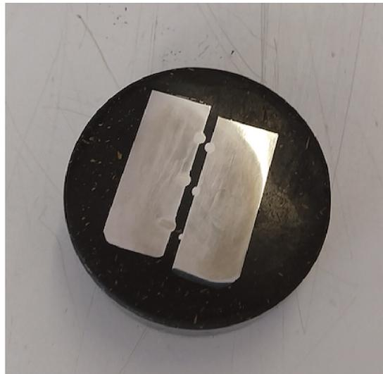
Figura 4 – Peça pronta para visualização em dispositivo ótico.
