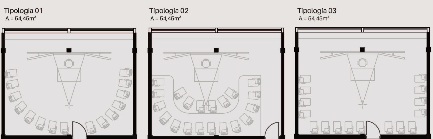
Tipologias criadas para as salas de aula do Bloco A, utilizadas pelo curso de Libras. Fonte: Elaborado pela autora, através de arquivo fornecido pelo DPAE.
