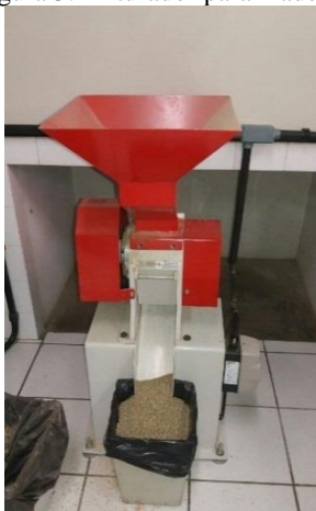
Figura 3: Triturador para madeira.
