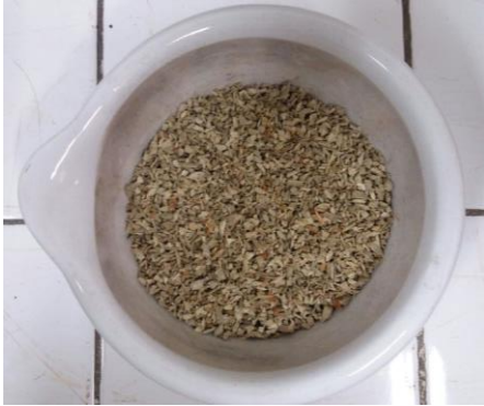
Figura 4: Amostra de madeira tratada com CCA cominuída.
