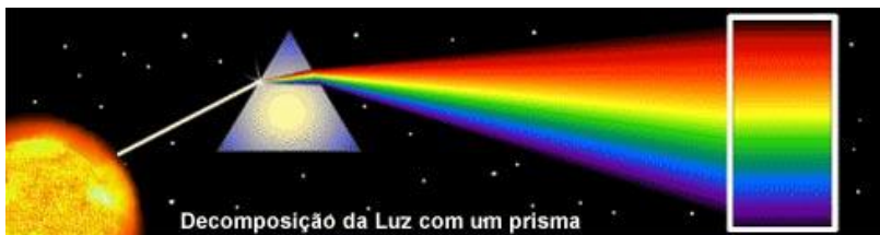
Figura 2: Espectroscopia consiste na análise do "espectro" produzido pela luz após atravessar um prisma ou uma rede de difração, capaz de decompor a luz vinda do espaço.
