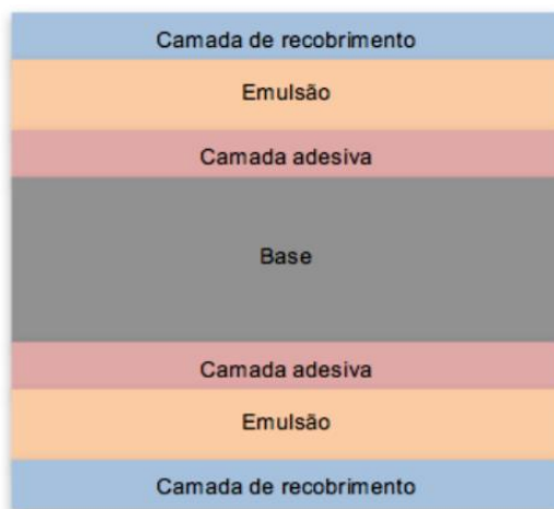
Figura 24: Filme radiográfico com sua divisão de camadas. Os fótons que sensibilizarem este filme, estarão formando a imagem que ficará “impressa”.
