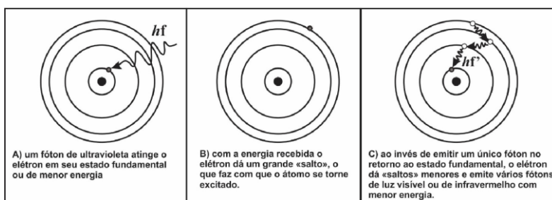
FIG. 1- Produção de fótons de luz visível a partir de um fóton ultravioleta
