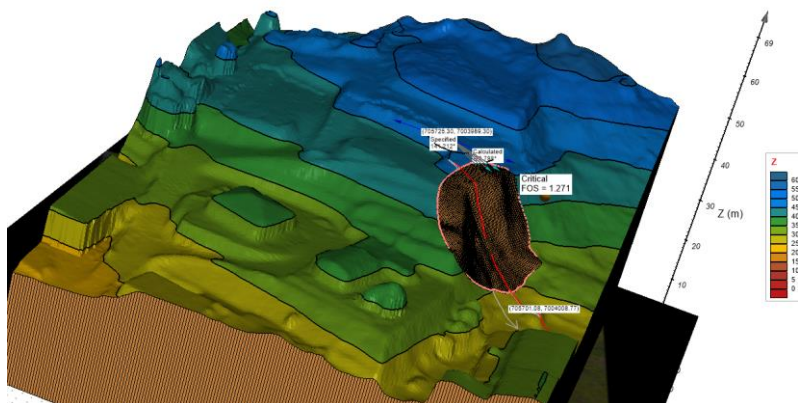
Figura 86 - Análise tridimensional com malha de 500x500 elementos.
