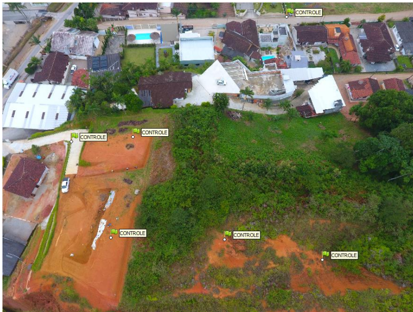
Figura 26 - Pontos de controle identificados em fotografia.
