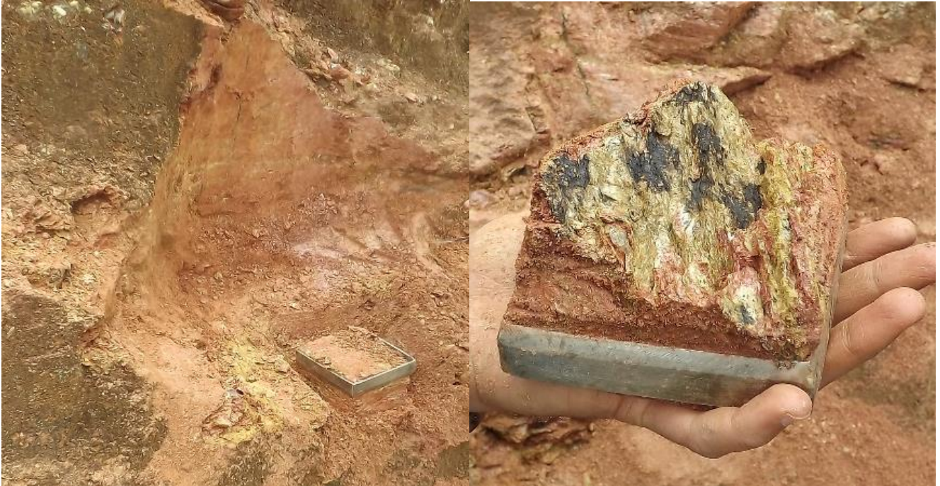
Figura 24 - Moldagem Estruturada de Corpos de Prova em Encosta.
