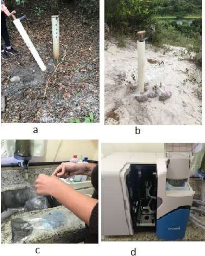
Figura 26- Coleta de amostras de solo no PZ14 (a). Coleta de amostras de solo no Ponto_alto (b). Homogeneização da amostra no laboratório (c) e analisador de partículas (d) Equipamento.
