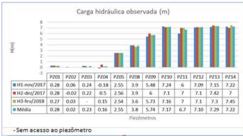
Figura 32- Carga hidráulica (m) observada nos piezômetros.
