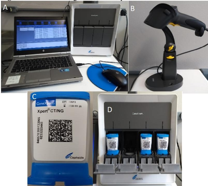
**A:** Equipamento GeneXpert® e computador com software; **B:** leitor de código de barras dos cartuchos; **C:** cartucho (onde é inserido a amostra e ocorre toda a reação de qPCR) e **D:** Equipamento GeneXpert®<sup>c</sup> carregado com cartuchos.
