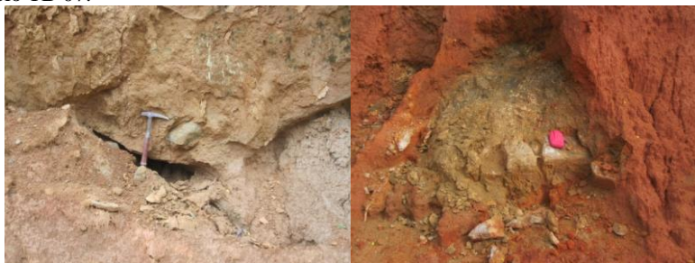
Figura 46 - Blocos de rochas identificados no depósito de encosta da amostra de solo TB 07.
