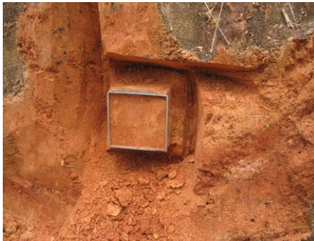
Figura 22 - Coleta de amostra indeformada com anel metálico de coleta para ensaio de cisalhamento direto.
