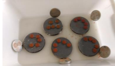
Figura 29b - Pastilhas sobre pedra porosa saturada.
