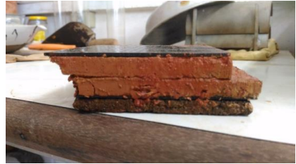
Figura 36b - Corpo de prova do solo após execução do ensaio.
