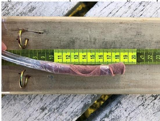
A diferença do nível d'água entre o tubo inserido no sedimento e a tubo no corpo superficial é a diferença de carga hidráulica ( $\Delta h$ ). Essa, dividida pela profundidade da seção filtrante ( $\Delta l$ ) configura-se o gradiente hidráulico vertical (GHv), conforme equação 7:
