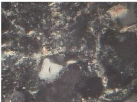
Figura 43: N.C. 25X - Quartzo monocristalino com crescimento sob pressão, feldspato alcalino e material argiloso.
