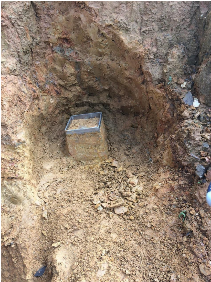
Figura 28: Coleta das amostras indeformadas para realização de ensaios de cisalhamento direto em laboratório.
