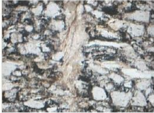
Figura 54: L.N. 10X - Grãos de quartzo e mica estirados na mesma direção e perpendicular ao lítio metamórfico.
