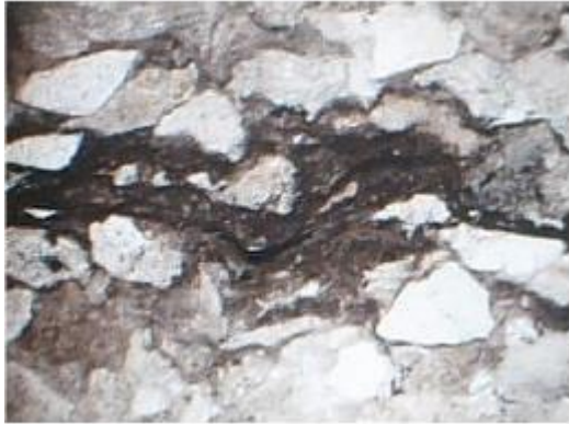
Figura 50: N.C. 10X - Filete de lamito sedimentar, irregular, envolvendo grãos de quartzo.
