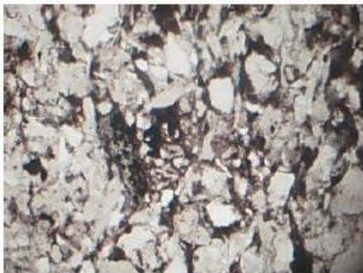
Figura 48: L.N. 4X - Lamito, lítio sedimentar, quartzo, feldspato e óxido de ferro.
