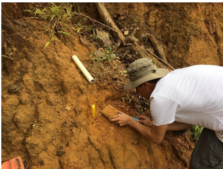
Figura 27: Coleta de amostras indeformadas para realização de ensaios de cisalhamento direto em laboratório.
