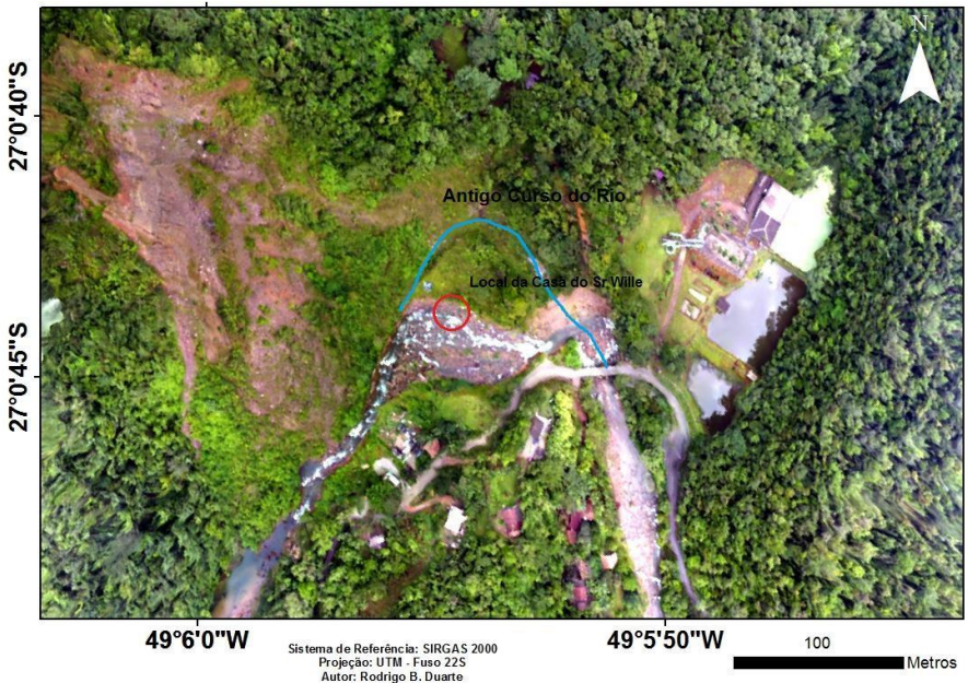
Figura 74: Ortofoto da área de estudo realizada com Vant/Drone, linha em azul indicando antigo trajeto do curso d'água, círculo em vermelho indicando o local da casa do Sr Wille que foi destruída após a mudança do trajeto do rio.
