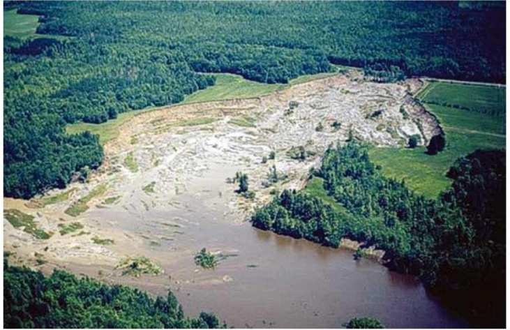
Figura 19: Fluxo de terra de Lemieux, 1993 — um rápido fluxo de terra ocorrido em argila marinha sensível, próximo a Ottawa, Canadá. O cume da escarpa regrediu 680 metros no nível do solo, passando por cima da margem do rio. Aproximadamente 2,8 milhões de toneladas de argila e silte liquifizeram e escorreram para o vale do rio South Nation, represando o rio (Imagem de G. R. Brooks do Geological Survey of Canada). Fonte: Manual de Deslizamento – USGS, 2008.
