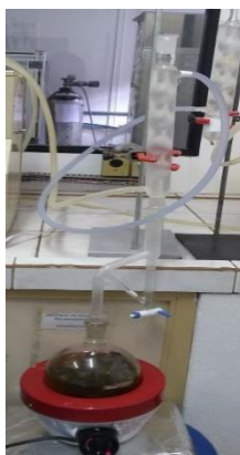
Figura 3.2: Extração por hidrodestilação (HD) da folha de louro.
