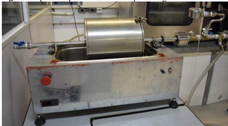
Figura 6. Aparato experimental utilizado para secagem das amostras.
