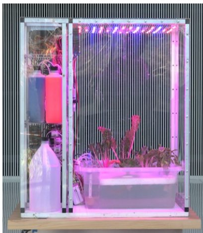
Figura 4 - Plataforma pessoal de controle de ambiente para cultivo de vegetais
