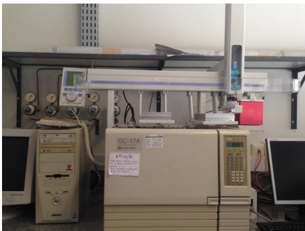
Figura 3 - Cromatógrafo gasoso utilizado para análise da concentração do benzoato de benzila
