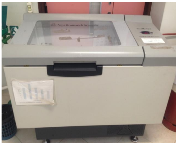
Figura 2 - Câmara incubadora com agitação orbital utilizada para a síntese enzimática do benzoato de benzila
