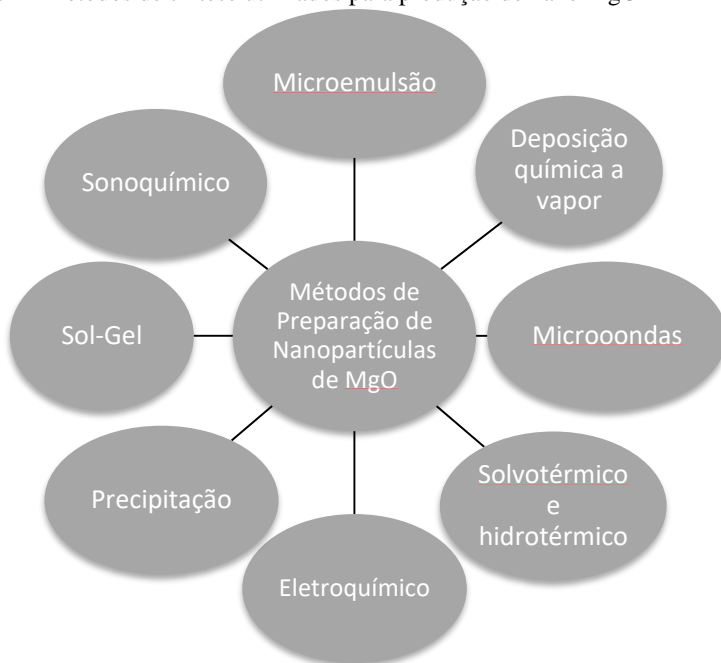
Figura 2 - Métodos de síntese utilizados para produção de nano MgO
