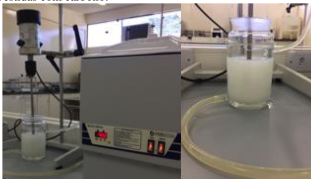
Figura 10 - Sistema experimental utilizado para a produção das nanoestruturas de MgO revestidas com carbono.
