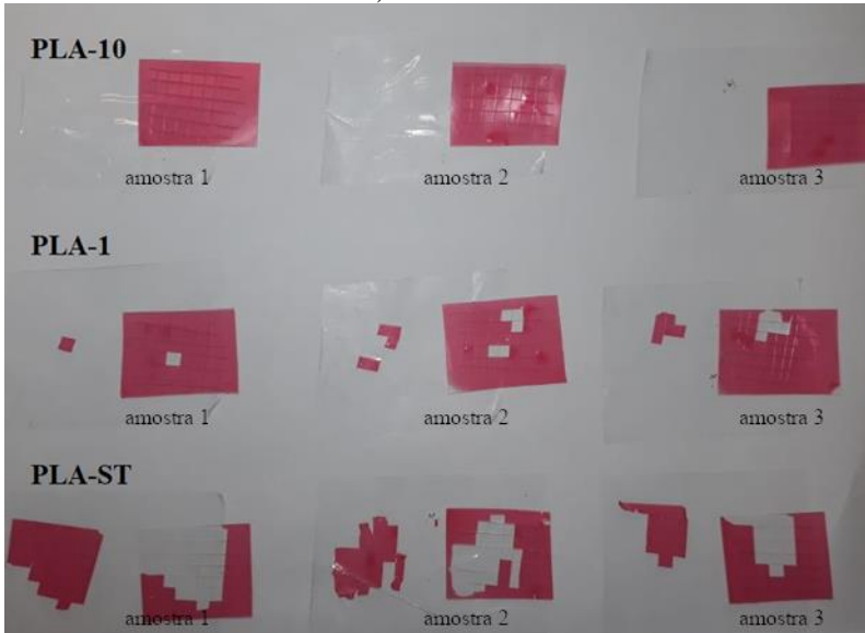
Figura 22. Resultados do teste da fita para os filmes multicamadas com PLA e amido. Esquerda: fita adesiva com a camada de amido removida; direita: filme multicamada com a camada de amido remanescente (para facilitar a visualização o amido foi colorido de vermelho).
