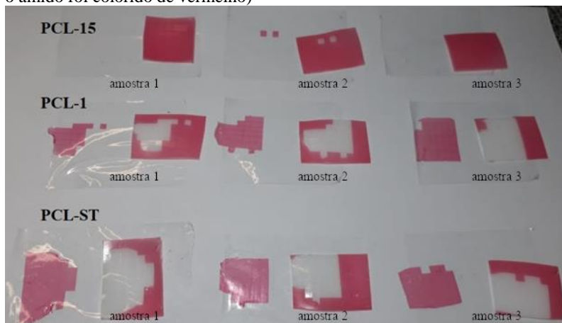
Figura 21. Resultados do teste da fita para os filmes multicamadas com PCL- e amido. Esquerda: fita adesiva com a camada de amido removida; direita: filme multicamada com a camada de amido remanescente (para facilitar a visualização o amido foi colorido de vermelho)
