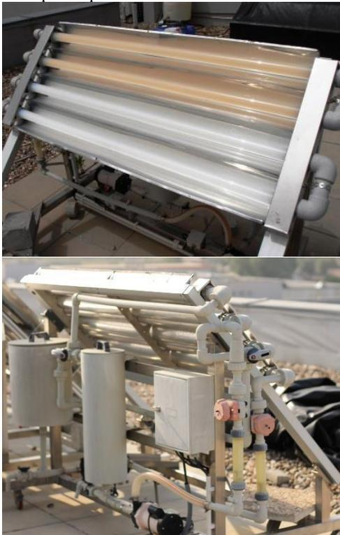
Conforme pode se observar na Figura 14, a planta piloto contém dois tanques, internamente cônicos, de recirculação (10 L e 25 L), duas bombas centrífugas (35 L/min), dois rotômetros e seis válvulas de polipropileno.
