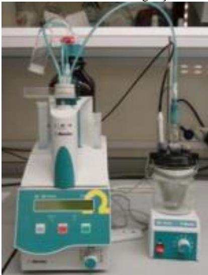
Uma vez que as soluções de base são facilmente contaminadas com CO<sub>2</sub>, N<sub>2</sub> foi borbulhado durante 20 min na célula para remover o CO<sub>2</sub> da solução.
