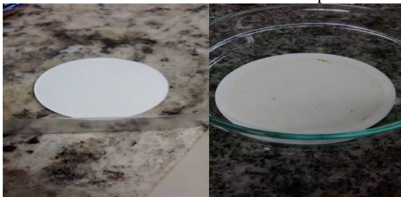
Figura 4.5 – Análise laboratorial – membrana: anterior e posterior a filtração
