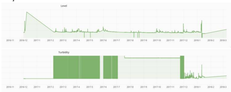
Figura 8.6 – Registros do sinal de nível (Level) e sinal de turbidez (Turbidity) da estação Ana D´Avila.
