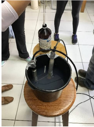
Figura 8.13 – Registro fotográfico dos sensores de turbidez sendo calibrados em 27/07/2017.
