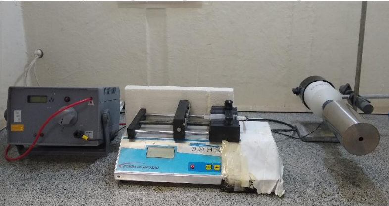
Figura 6 - Imagem do aparato experimental utilizado para eletrofiação.
