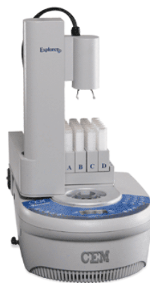
Figura 5. Imagem ilustrativa de um reator de micro-ondas com controle de pressão.
