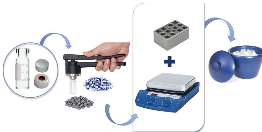
Figura 28. Demonstração do procedimento experimental do estudo da termólise das vinil azidas 3a e 3c .
