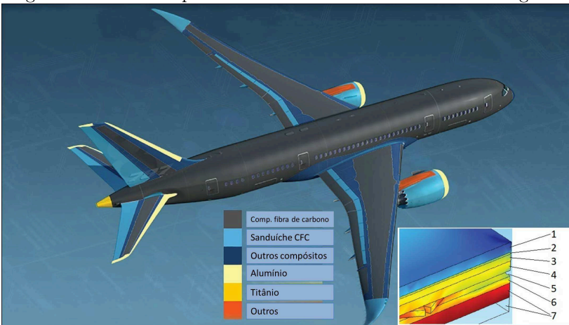
Figura 5 – Materiais presentes na estrutura da aeronave Boeing 787.
