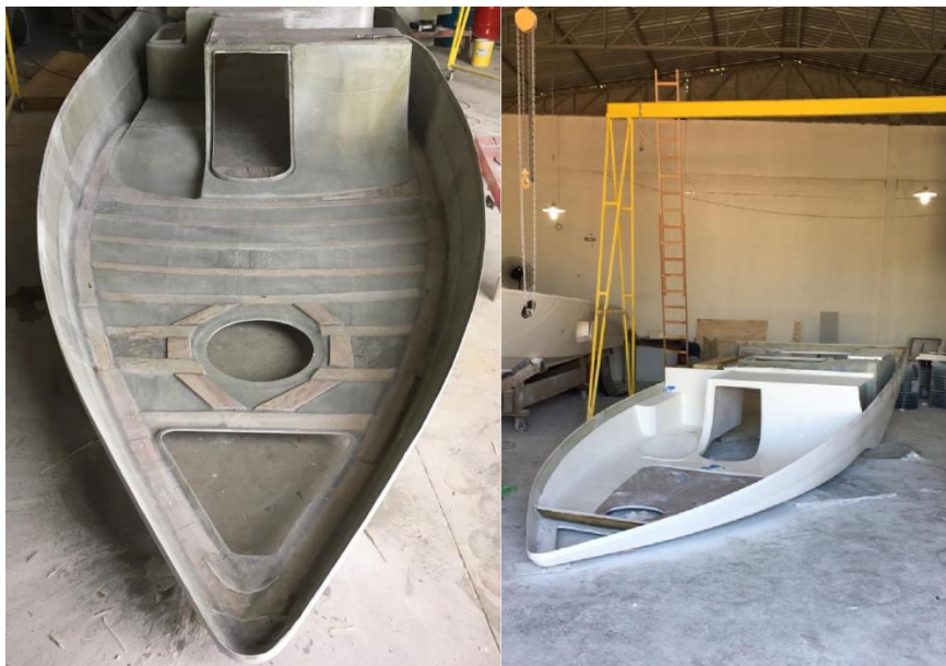
Figura 16 – Submontagem do convés
