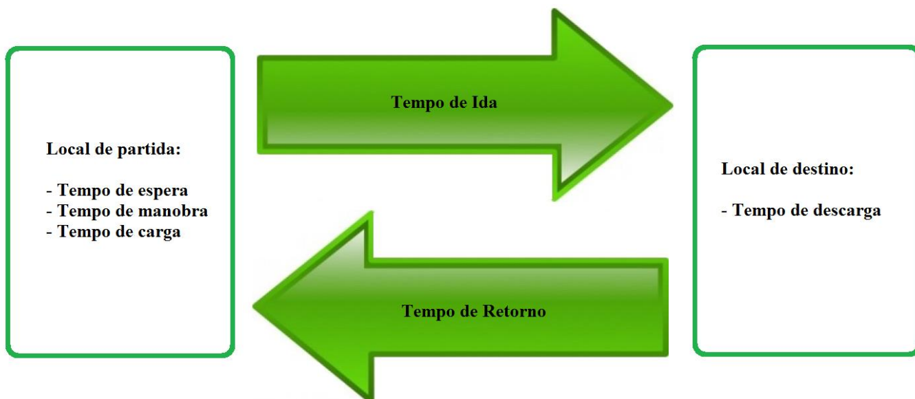
Figura 14 – Tempo de ciclo do caminhão basculante.
