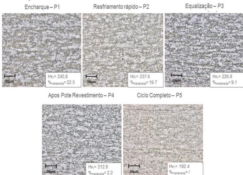
Figura 4.3 - Análise metalográfica das amostras simuladas por dilatometria com temperatura de recozimento de 780°C.
