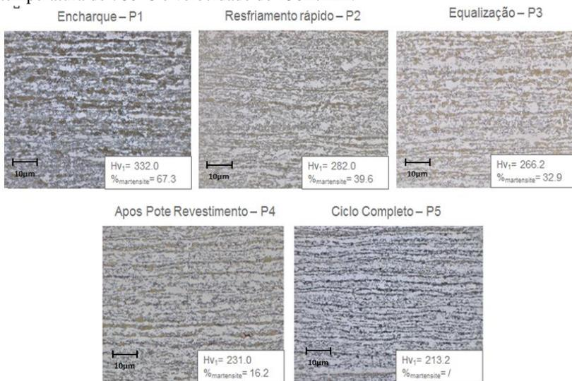
Figura 4.13 - Análise metalográfica realizada após ciclo de recozimento completo simulado por dilatometria para temperatura de 780°C e velocidades de 60, 100 e 150m/min.
