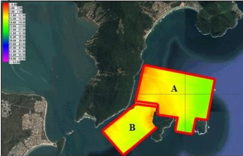
Figura 32. Levantamento completo com sistema interferométrico.
