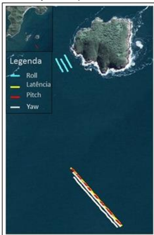
Figura 31. Linhas sondadas para realização dos Patch test .
