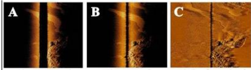
Figura 34. A: Sem Bottom track ; B: Com Bottom track ; C: Com Filtros.
