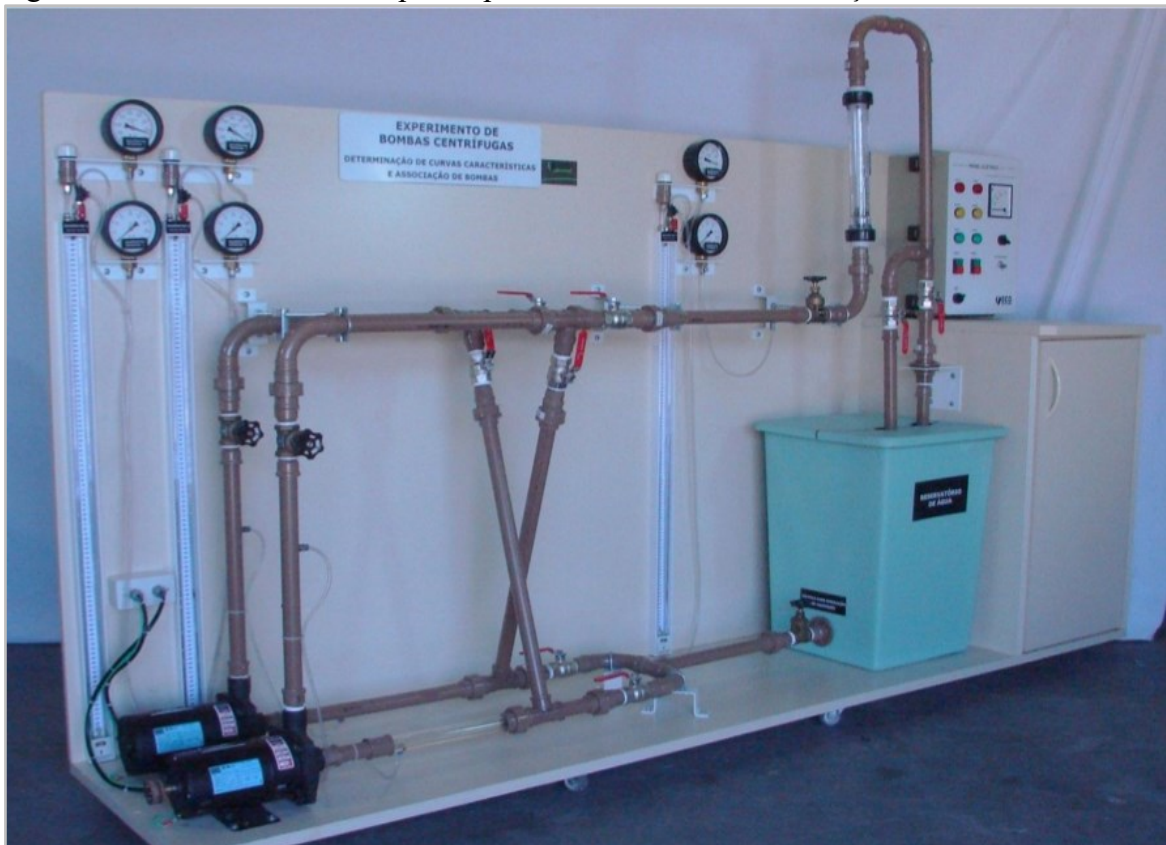
Figura 10 – Estrutura física do protótipo de bombeamento e cavitação situado no LabHidra.
