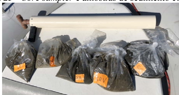
Figura 25 - Core sampler e amostras de sedimento coletadas
