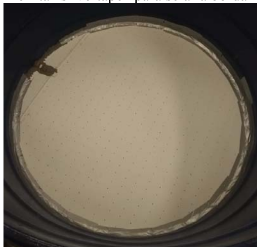
Figura 16 - Base difusora encaixada no fundo do tanque de fluxo, com massa para calafetação e fita “silvertape” para selar a borda
