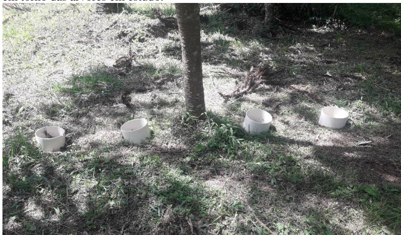
Figura 11 - Suporte de PVC para os leitores de fluxo de CO 2 no solo, dispostos em torno das árvores em estudo.
