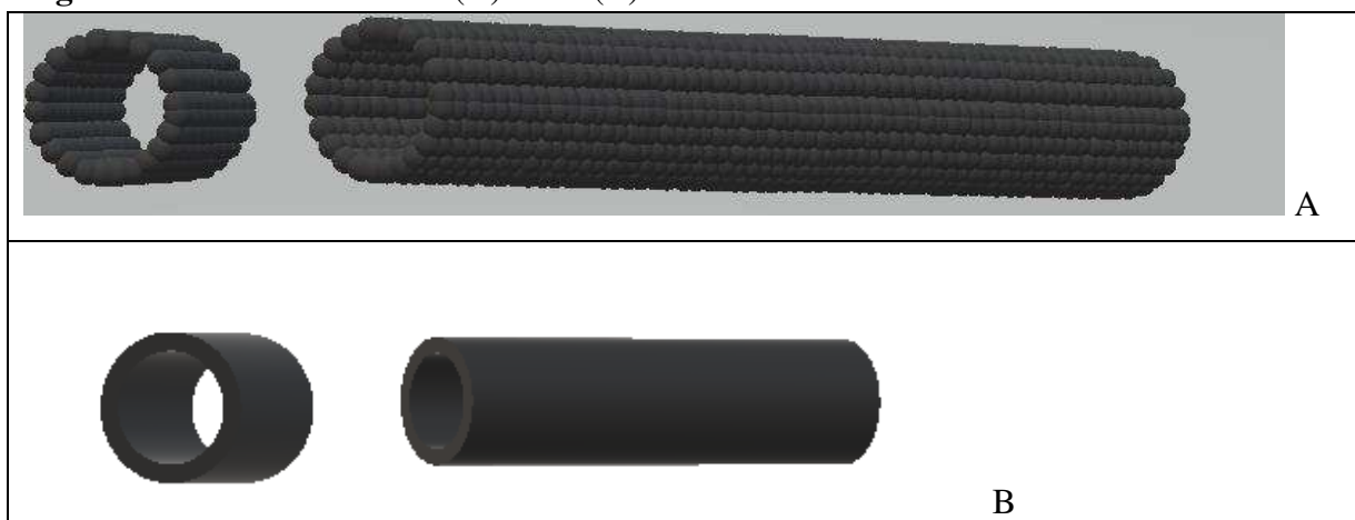
Figura 24. Estrutura do CNT (A) CB e (B) Convencional.
