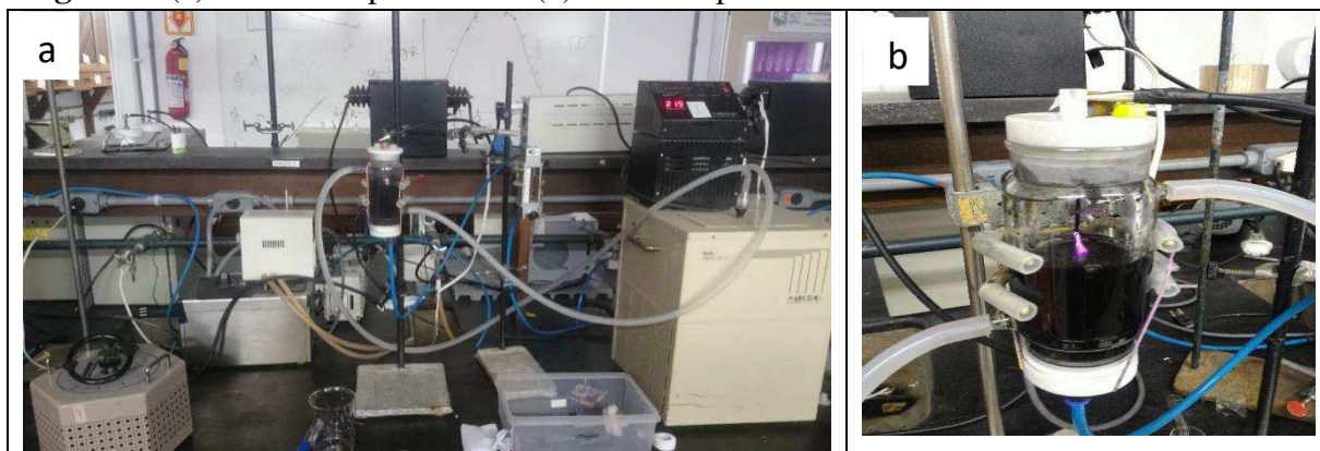
Figura 7. (a) Sistema de plasma frio (b) reator de plasma frio
