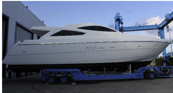
Figura 6 – Yacht produzido em plástico reforçado com fibra de vidro
