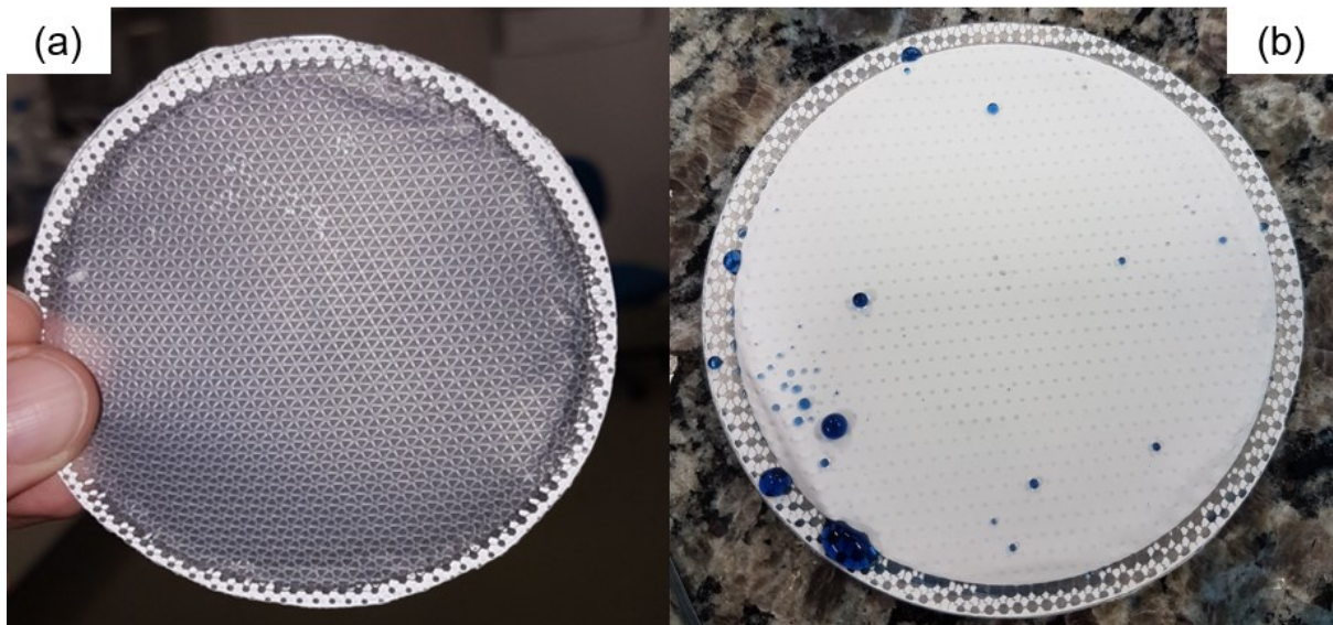
Figura 28 – Fotografia da membrana (a) após DM com solução de água e surfactante e (b) após a DM com solução de água e corante PR
