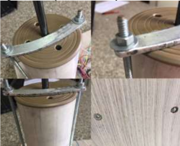
Figura 29 - Fixação do cilindro na plataforma.
