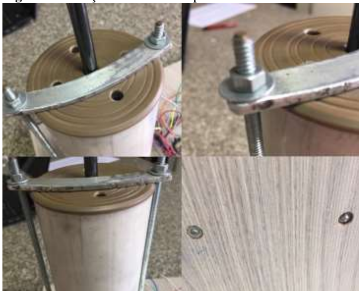
Figura 26. Fixação do cilindro na plataforma.
