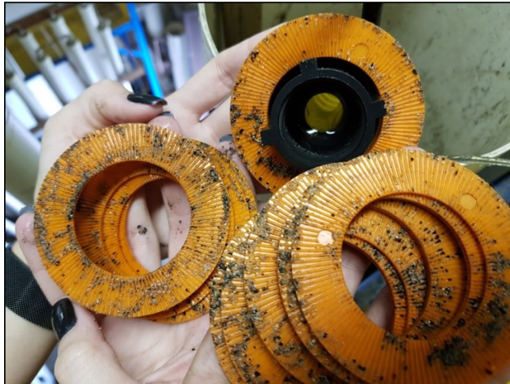
Figura 35: Detalhe das passagens entre os discos, obstruídas por material filtrante
