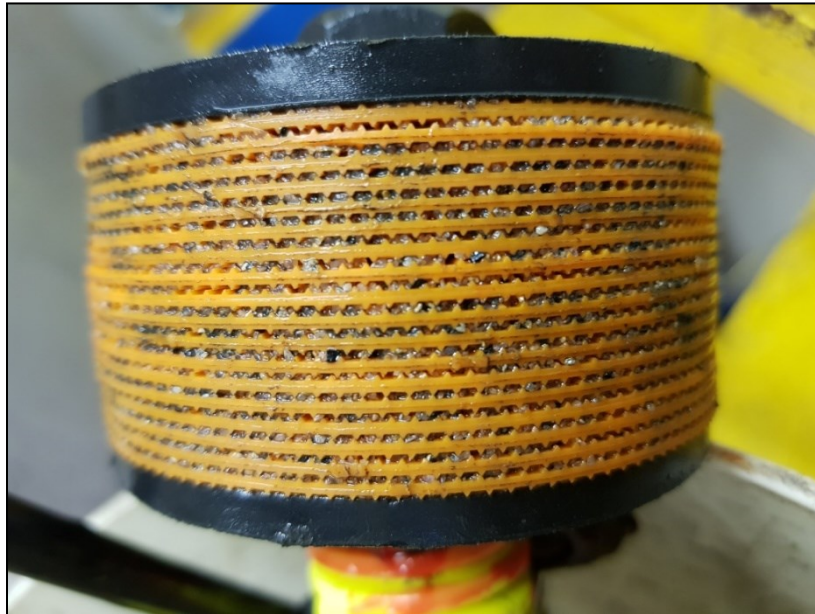
Figura 33: Detalhe dos sulcos do bocal obstruídos por material filtrante
