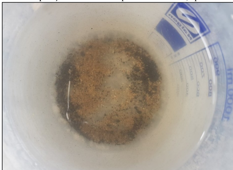
Figura 37: Composição do material depositado no bocal, após desobstrução
