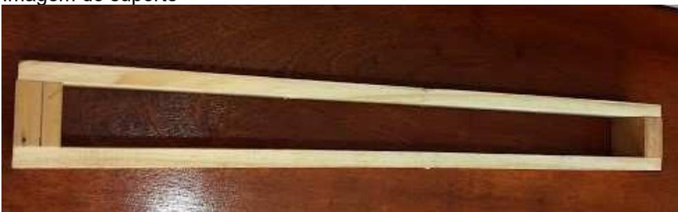
Com a estrutura construída use o transferidor e com a rampa, meça os ângulos desejados (no nosso caso ângulos de 15°, 30° e 45°), faça as marcações no suporte e fure o suporte, por onde será colocado o parafuso. Observe a imagem de como a estrutura deve ficar no final do processo.
