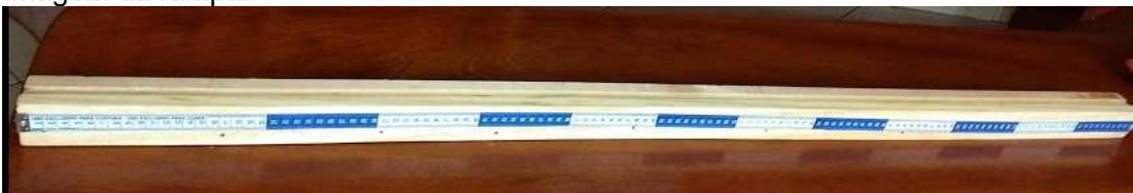
Para construir o suporte use os pedaços de madeira de 70 cm de comprimento e as duas de 4 cm de comprimento com o uso de pregos. Monte a estrutura conforme a imagem abaixo:
