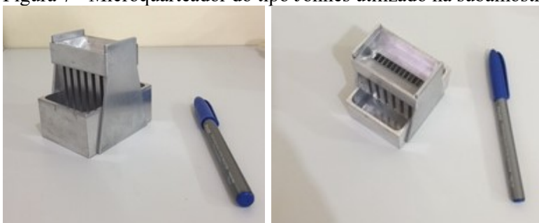
Figura 7 - Microquarteador do tipo Johnes utilizado na subamostragem das amostras.
