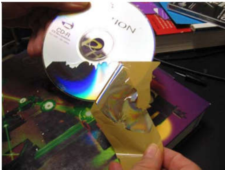
Figura 1. Removendo a parte espelhada do CD. Fonte [BALACHANDRAN; PORTER-DAVIS ,2009]
