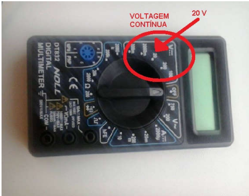
Figura 1. Em corrente contínua, deixe o multímetro em 20 V.
