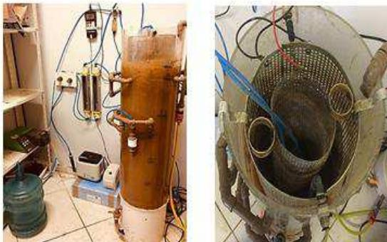
O módulo de membrana utilizado na unidade experimental foi adquirido junto a fabricante canadense Zenon/General Eletric. O módulo em questão (ZeeWeed-10) possuía conformação do tipo fibra oca, diâmetro dos poros de  $0,04 \mu\text{m}$  e área filtrante de  $0,93 \text{ m}^2$ . Na Figura 5 é apresentado a imagem do módulo de membrana, assim como a sua representação esquemática.
